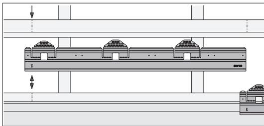
Die Starterprofile werden auf die vertikalen Schnürung ausgerichtet und mit min. 3 Stk Nagel 2.5×35 mm befestigt.
