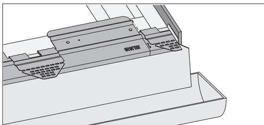
Am rechten Ort, wenn mit einer ganzen Structa-Platte eingeteilt ist, muss zusätzlich ein Abschnitt eines Starterprofils hinterlegt werden.
