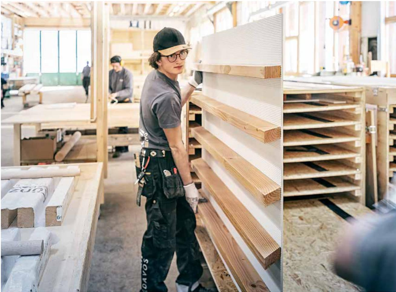
Für die wellenförmige Prägung der Faserzementplatten mussten Polyethylen-Matrizen gefräst werden (r.). Die fertig geprägten Platten werden dann in der Werkhalle des Holzbauers auf vertikale Latten geschraubt (o.). Der im Rendering sichtbare Fassadenausschnitt zeigt, wo sie zum Einsatz kommen (l.).
